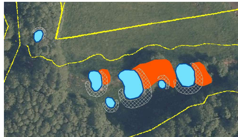
Rozsah prováděných zásahů v roce 2012: modře – budování tůní, šrafovaně-uložení zeminy, oranžově - kácení dřevin
